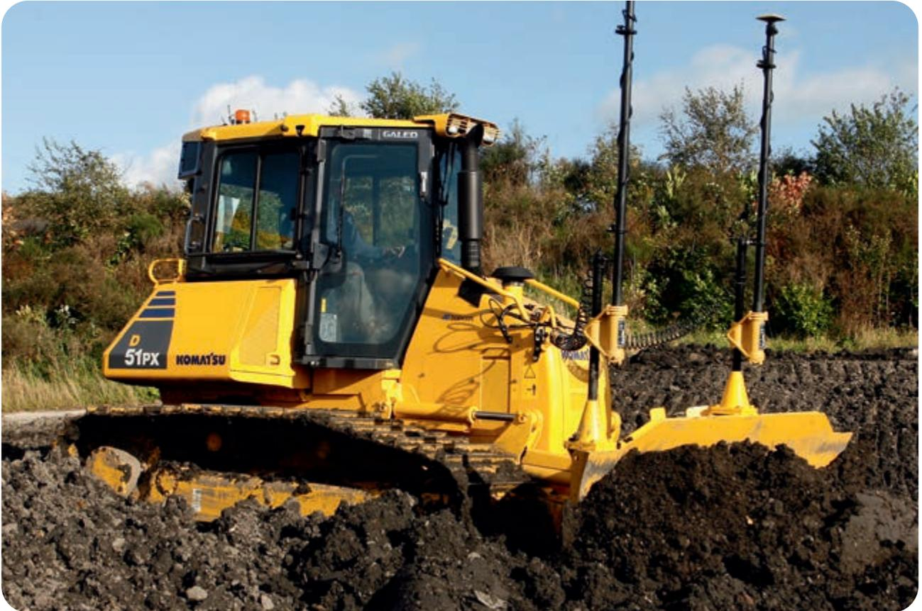
Los cojinetes del tren resistente a la abrasión se someten a un potente tratamiento térmico. Está disponible con eslabones de alto rendimiento o convencionales, dependiendo de la máquina. Desarrollado para bulldozers Komatsu de tamaño mediano (D41, D51, D61, D65), AR ha sido específicamente diseñado para aplicaciones abrasivas y de bajo impacto.
