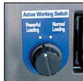
Il selettore consente due modalità di lavoro: Powerful o Normal. Nella modalità Powerful il flusso di olio alle attrezzature di lavoro può essere aumentato e ridotto a seconda della necessità. Nella modalità Normal l'intero flusso di olio idraulico viene trasferito direttamente alle attrezzature di lavoro.
