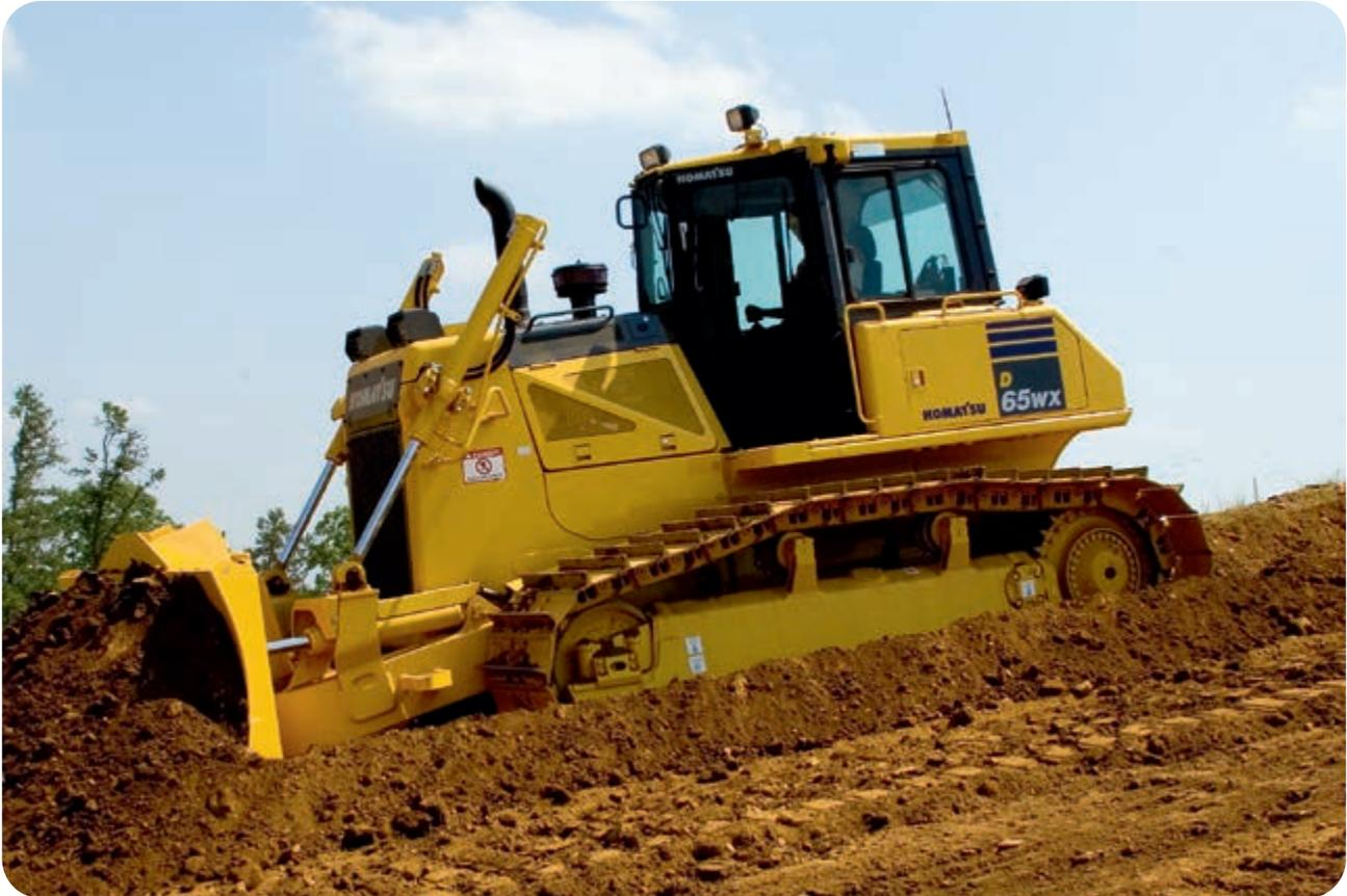
Die HD-AIR-Ketten wurden von Komatsu für die D65 und D85 Planiertraupen entwickelt. Die AIR-Buchsen sind widerstandsfähiger als die konventioneller Ketten und flexibler als die der AR-Ketten. Dadurch ist dieses Laufwerk besonders für Einsätze auf abrasivem Material und mit hoher Stoßbelastung geeignet. Die HD-Kettenglieder sind größer und haltbarer als bei Standard-Ketten.
