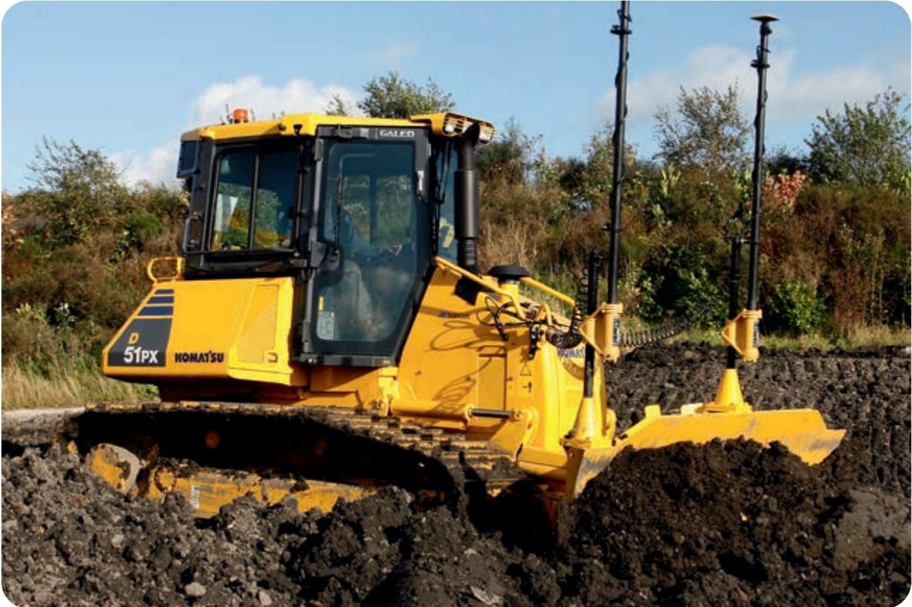
Die Buchsen der AR-Ketten wurden sorgfältig gehärtet. Je nach Maschinenmodell sind die Ketten mit HD- oder Standardkettengliedern erhältlich. Das AR-Laufwerk wurde für die mittelgroßen Planiertrauben von Komatsu entwickelt (D41, D51, D61, D65) und ist speziell für Einsätze auf abrasivem Material und mit geringer Stoßbelastung geeignet.
