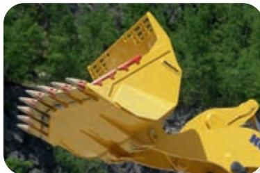
Verschleißplatten. Zusätzlich sind Schaufelecken, Seitenschneiden und Überlaufschutz verstärkt.
