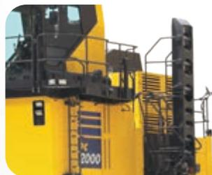
Rutschfeste Trittstufen, breite Trittstege und große Handläufe sorgen für sicheren und einfachen Zugang zur Kabine und den Wartungspunkten.
