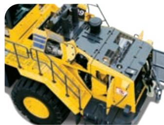
Rutschfeste Trittstufen, breite Trittstege und große Handläufe sorgen für sicheren und einfachen Zugang zur Kabine und den Wartungspunkten.
