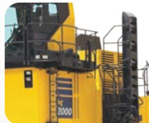
Los escalones aserrados, las plataformas y los pasamanos anchos permiten acceder a la cabina y a los puntos de mantenimiento fácilmente y con seguridad.
