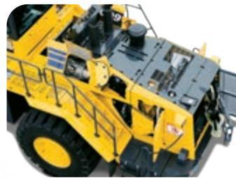
Los escalones aserrados, las plataformas y los pasamanos anchos permiten acceder a la cabina y a los puntos de mantenimiento fácilmente y con seguridad.
