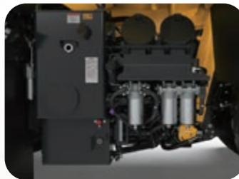
Les filtres et les points de graissage sont centralisés pour une maintenance quotidienne et un entretien plus faciles
