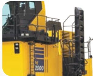
Les marches perforées, les passerelles larges et les mains courantes permettent un accès facile et sûr à la cabine et aux points de maintenance.
