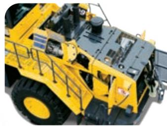
Les marches striées, les passerelles larges et les mains courantes permettent un accès facile et sûr à la cabine et aux points de maintenance.
