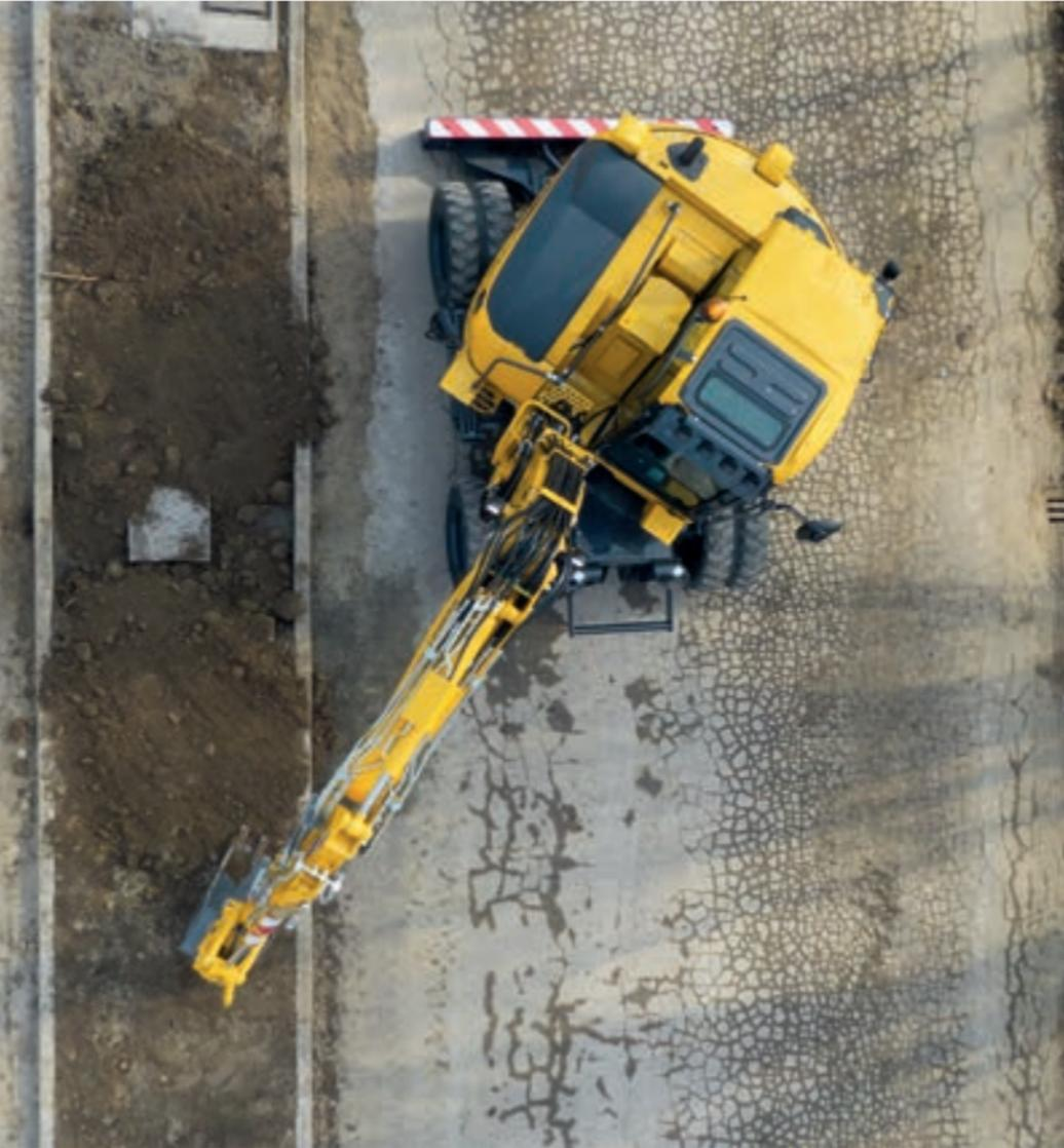
Die kompakten Mobil- und Kettenbagger von Komatsu wurden speziell für Einsätze auf engen Baustellen und an schwer zu erreichenden Einsatzorten entwickelt. Diese universell einsetzbaren und flexiblen Maschinen besitzen hierfür besondere Eigenschaften und Sonderausrüstungen wie z.B. den Auslegerversatz und können in unterschiedlichen Konfigurationen geliefert werden.
