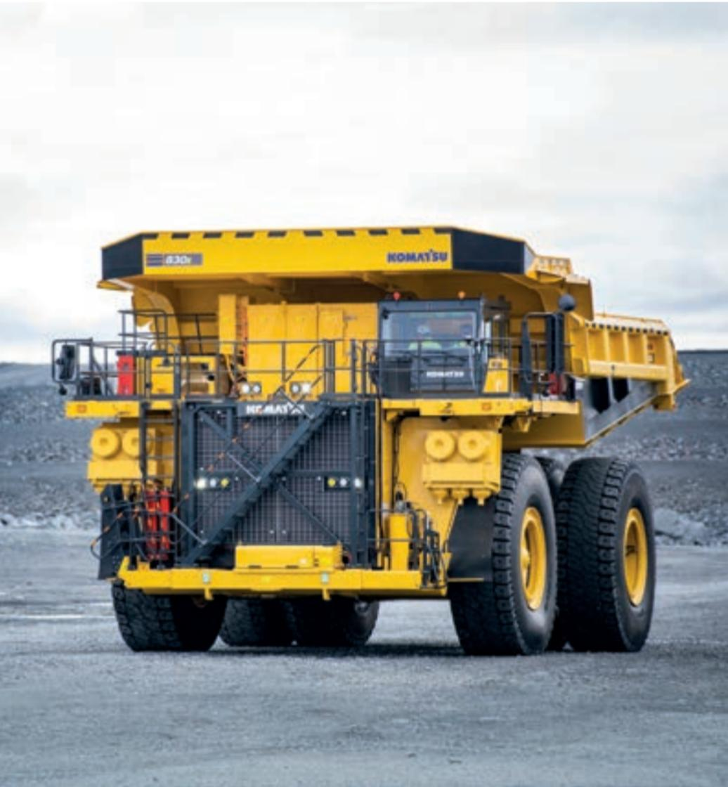
Muldenkipper von Komatsu transportieren schwerste Lasten schnell, einfach und kosteneffizient. Erhältlich als Starrrahmen-Muldenkipper oder in knickgelenkter Ausführung, zeichnen sie sich mit ihren leistungsstarken Komatsu-Motoren durch konkurrenzlos hohe Kraft aus. Auch bei hoher Fahrgeschwindigkeit ist höchste Sicherheit gewährleistet.
