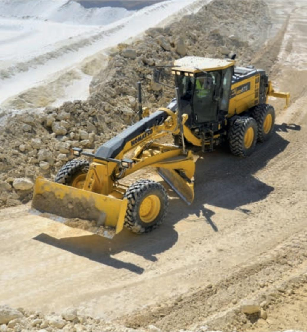
Die Motor-Grader von Komatsu sind kraftvoll, bieten eine hervorragende Steuerung, geringe Emissionen und sind mit einem Antriebsstrang mit Automatikgetriebe und Wandlerüberbrückung sowie wählbaren Betriebsarten ausgestattet. Eine unschlagbare Kombination aus Spitzenleistung und geringen Betriebskosten. Der lange Radstand und der große Rahmenknickwinkel ermöglichen aggressive Scharwinkel und einfaches und präzises Nivellieren.
