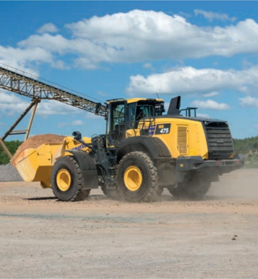
Las palas de ruedas de Komatsu se están usando en todo el mundo tanto como cargadoras multiusos en operaciones de movimiento de tierras como equipos de carga y transporte en canteras. Además, gracias a su elevado valor de reventa y a su larga vida útil. Estas máquinas resultan cómodas, eficientes y respetuosas con el medio ambiente. La WA475-10 introduce una nueva generación de palas de ruedas equipadas con la exclusiva tecnología de Transmisión Hidráulica Mecánica Komatsu (K-HMT).
