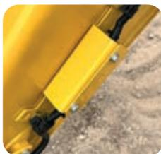
4 IMU (Unità di misurazione inerziale)
