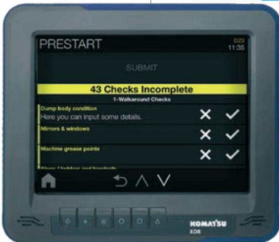
Der zusammengefasste PreStart-Bericht kann einfach eingerichtet und für die Überprüfung oder für Baustellenaudits zur Verfügung gestellt werden.
