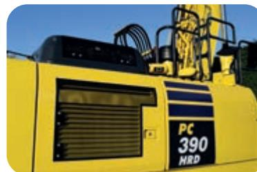
Pour encore augmenter la disponibilité de la machine, Komatsu propose en option une pré-filtration d'air et d'une grille
