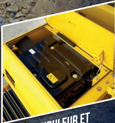
ENSEMBLE MOTEUR- GÉNÉRATEUR DE ROTATION ÉLECTRIQUE
