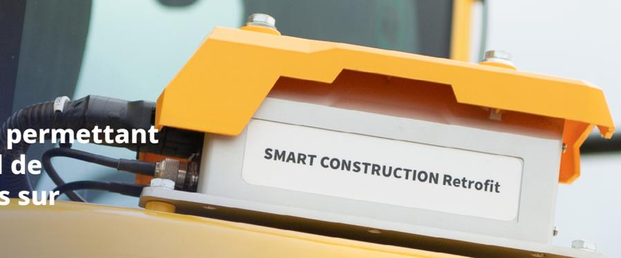
Toutes nos solutions sont rendues uniques par leur parfaite intégration à l'écosystème Smart Construction. Notre kit de guidage 3D Retrofit ne fait pas exception. Son rôle ? Collecter les données du chantier directement à partir des machines pour permettre aux conducteurs travaux et chefs de chantier d'analyser les informations du terrain, des matériaux, des machines et des opérateurs. Le tout pour apporter des informations
