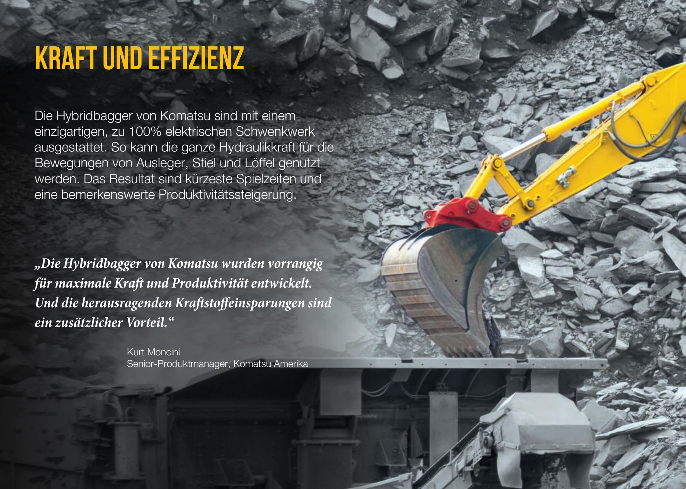
Die Hybridbagger von Komatsu sind mit einem einzigartigen, zu 100% elektrischen Schwenkwerk ausgestattet. So kann die ganze Hydraulikkraft für die Bewegungen von Ausleger, Stiel und Löffel genutzt werden. Das Resultat sind kürzeste Spielzeiten und eine bemerkenswerte Produktivitätssteigerung.
