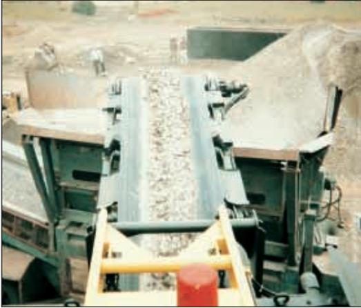
Einfachste Einstellung der Spaltweite mit dem von Komatsu entwickelten Einstellmechanismus, nachstellfreie Spannfedern, guter Zugang zu allen Wartungspunkten, eine hydraulische Presse im Lieferumfang und vieles mehr senken den Zeitbedarf für kleinere Servicearbeiten.
