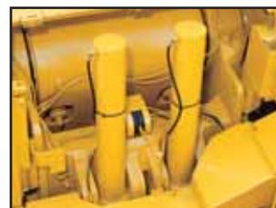
Hydraulischer Schutzmechanismus des Brechers
