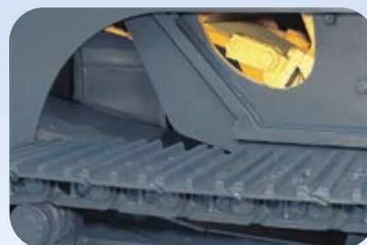
Apertura su lato frantumatore (entrambi i lati del sottocarro)
