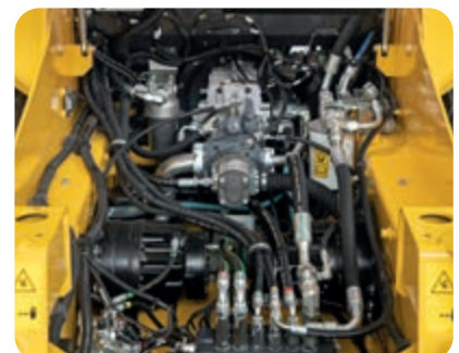
Für den Zugang zum Hauptsteuerblock und den Hauptkomponenten des Hydrauliksystems kann die Kabine innerhalb weniger Minuten gekippt werden
