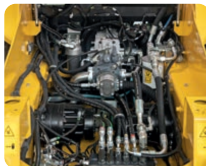
La cabina tiltabile può essere sollevata in pochi minuti, garantendo un facile accesso alla valvola principale e ai componenti idraulici più importanti
