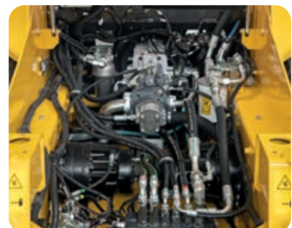
Den tiltbara hytten kan höjas på bara några minuter för att ge enkel åtkomst till huvudventilen och viktiga hydraulkomponenter
