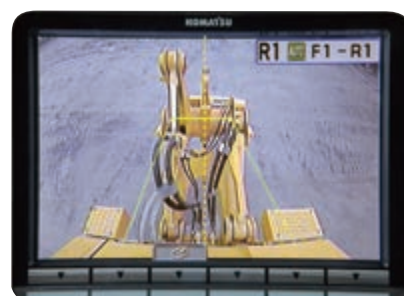
Sistema integrado de cámara para visibilidad trasera
