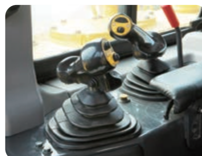
Palanca de control de la hoja con función de pitch automático y nueva palanca de control del ripper con función de retorno automático
