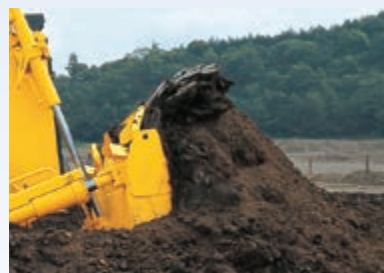
Der Sigmadozer®-Schild bietet maximales Volumen und minimalen Materialverlust
