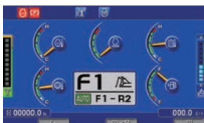
Automatische Gangwechsel reduzieren zusätzlich den Kraftstoffverbrauch
