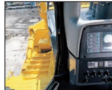
wird die Effektivität beim Planieren erhöht. Durch die spezielle Form des Tanks hat der Fahrer auch beim Reiben freie Sicht, dies reduziert die Arbeitszeit drastisch.
