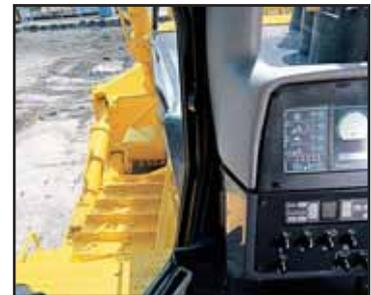
wird die Effektivität beim Planieren erhöht. Durch die spezielle Form des Tanks hat der Fahrer auch beim Reiben freie Sicht, dies reduziert die Arbeitszeit drastisch.
