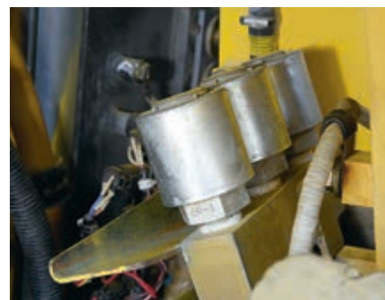
Gli sfiati tipo Canister facilitano le operazioni di controllo e di pulizia (optional)
