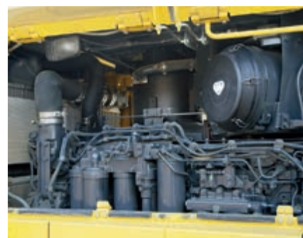
Punti di controllo centralizzati
