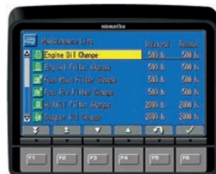
Monitor di controllo manutenzione
