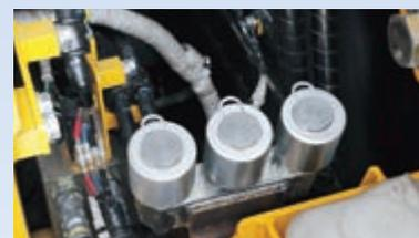
Entlüfterdosen erleichtern die Überprüfung und Reinigung (optional)
