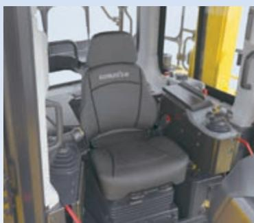
Der Sitz ist um 12° zur Seite gedreht um maximalen Fahrerkomfort beim Planieren und Aufreißen zu bieten
