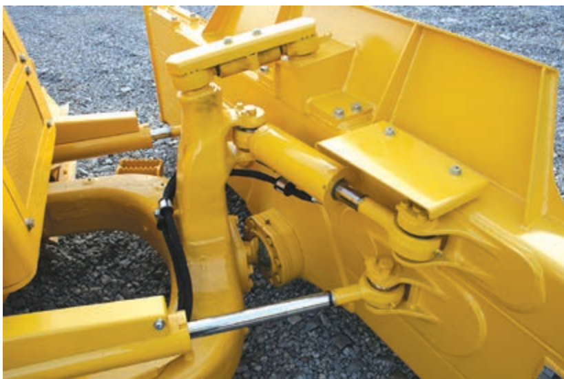
Gerader Brust-Tiltschild (PAT) mit verstellbarem Schnittwinkel
