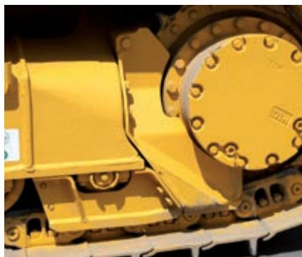
Protège-galets inférieur, section centrale et section d'extrémité
