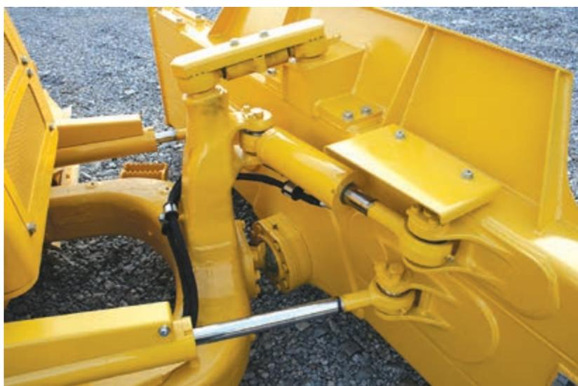
Lame inclinable à angle de coupe droit (PAT) à hauteur réglable
