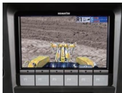
Système de caméra vue arrière complètement intégré
