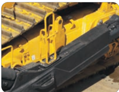
Isolationskasten für Batterie und Startermotor mit Anschluss für Starthilfekabel
