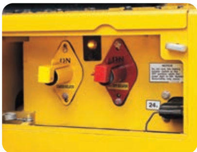
Isolationskasten für Batterie und Startermotor mit Anschluss für Starthilfekabel
