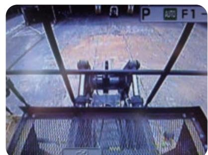
Système de caméra vue arrière complètement intégré
