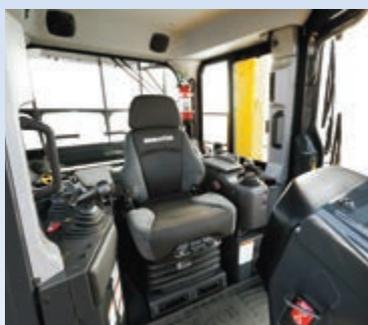
Le siège est désormais fixé à un angle de 12° pour un confort optimal lors du boutage et du rippage
