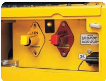
Caisson batterie et isolateur de démarreur avec prise pour démarrage par câbles
