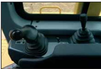
Joystick di comando e leva comando ripper
