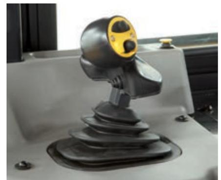
PCCS-Bedienhebel (Palm Command Control System) mit Wahltaaste für automatische/manuelle Schildsteuerung
