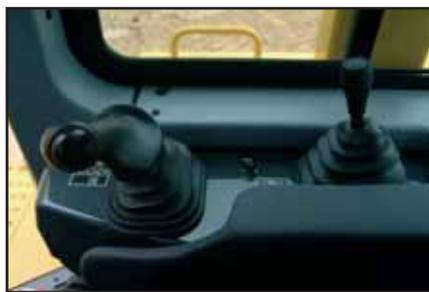
Joystick de contrôle de la lame et du ripper
