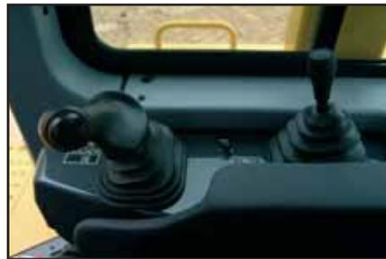
Joystick di comando lama e leva comando ripper
