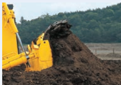
Het Sigmodozer®-blad zorgt voor een optimale vulling en verdeling
