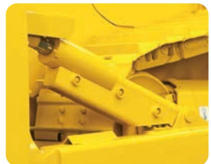
Dans la mesure du possible, les conduites hydrauliques sont intégrées dans les structures
