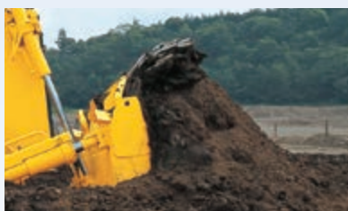
Der Sigmodozer®-Schild bietet maximales Volumen und minimalen Materialverlust
