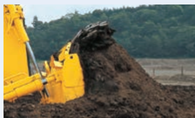
La lama Sigmadozer® offre una maggiore capacità di materiale
