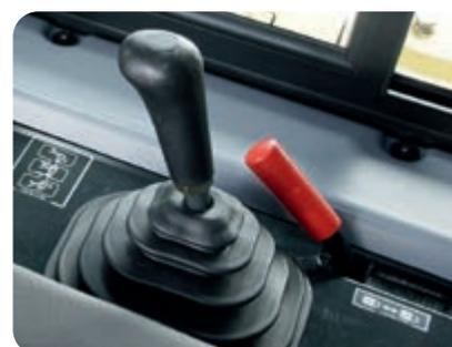
Leve di bloccaggio di comodo azionamento
