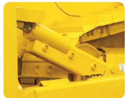
Le tubazioni idrauliche sono prevalentemente integrate nella struttura
