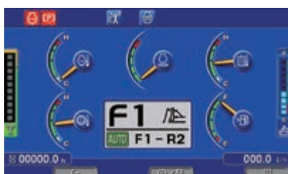
Automatische schakelfunctie voor verdere reductie van het brandstofverbruik
