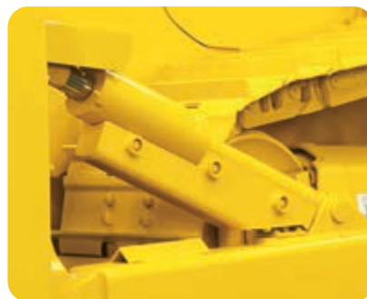
De hydraulische leidingen zijn zoveel mogelijk in de structuren geïntegreerd
