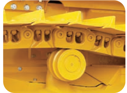
Einzelne Kettenglieder können mit herkömmlichen Kettenwerkzeugen ausgetauscht werden
