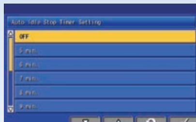
L'arrêt moteur automatique réglable en cas de ralenti prolongé éteint automatiquement le moteur après une période d'inactivité prédéfinie. De plus, la nouvelle fonction d'auto-décélération ralentit automatiquement le régime moteur lorsque les leviers sont en position neutre pendant une durée déterminée.
