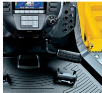
Die neue Ausführung mit nur einem Pedal macht die Steuerung so einfach wie noch nie. Die Bremsfunktion wurde in das Negativ-Gaspedal integriert, so dass die Fahrgeschwindigkeit der Maschine über nur ein Pedal gesteuert werden kann. Die Funktion des Pedals wählt man über einen Taster.
