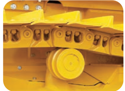
Los eslabones de la cadena pueden sustituirse con herramientas convencionales
