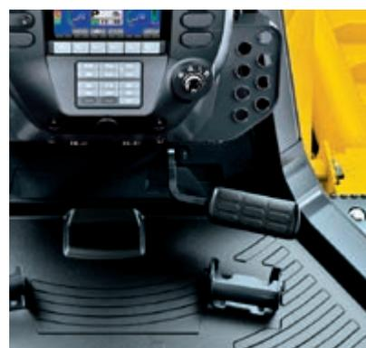
Il funzionamento della macchina è semplice con il nuovo design a un pedale che integra la funzione del freno nel pedale del deceleratore. La velocità di marcia della macchina può essere controllata con un solo pedale. La funzione del pedale può essere cambiata da un selettore di modalità.
