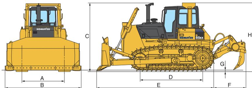
Dimensioni con lama semi-U con tilt e ripper multidenti (D85EX-15)
