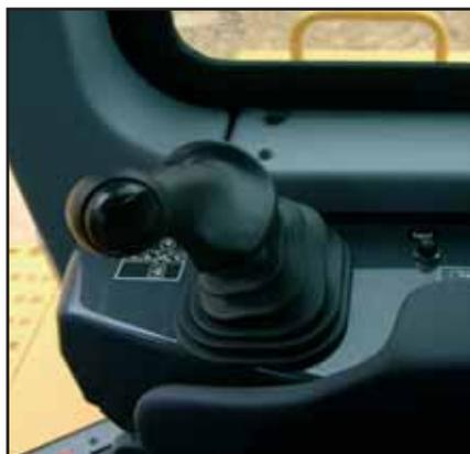
Il comando PPC assicura una risposta proporzionale ai movimenti del joystick, fornendo in questo modo all'operatore un riscontro sensoriale delle operazioni della lama, migliorando la precisione del lavoro che viene eseguito.
