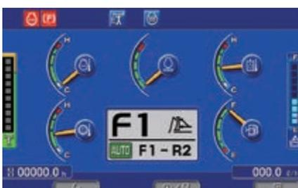
Automatische Gangwechsel reduzieren zusätzlich den Kraftstoffverbrauch
