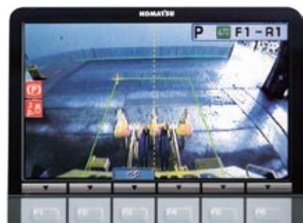
Système de caméra vue arrière complètement intégré
